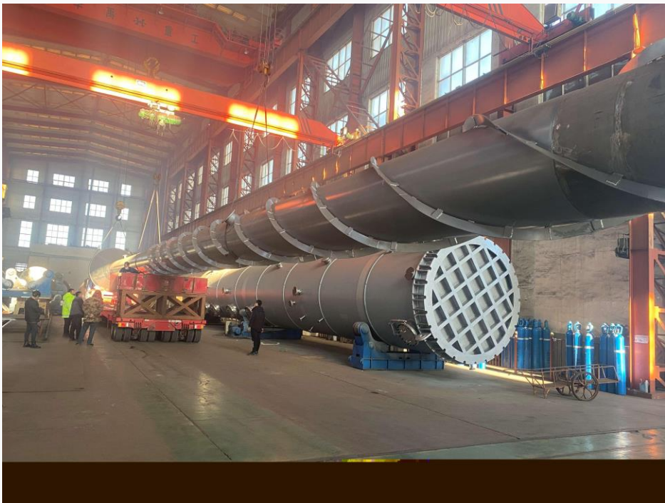
中国石油化工股份有限公司天津分公司 净化塔 \Phi 3000/\Phi 1000 \times 63000 ， S31603/Q345R、N10276/ S31603 (奥氏体不锈钢复合板、哈氏合金复合板)
