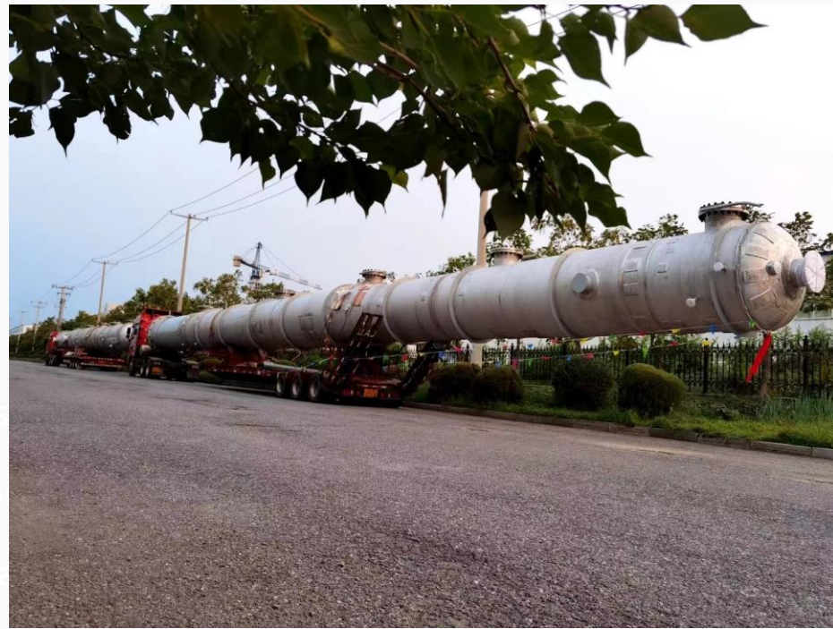
山东滨海鲁清石化有限公司 (10t/h干气脱硫单元) 酸性水汽提塔 \Phi 2200/\Phi 1200 \times 51675 ， S11348/Q245R (铁素体不锈钢复合板)
