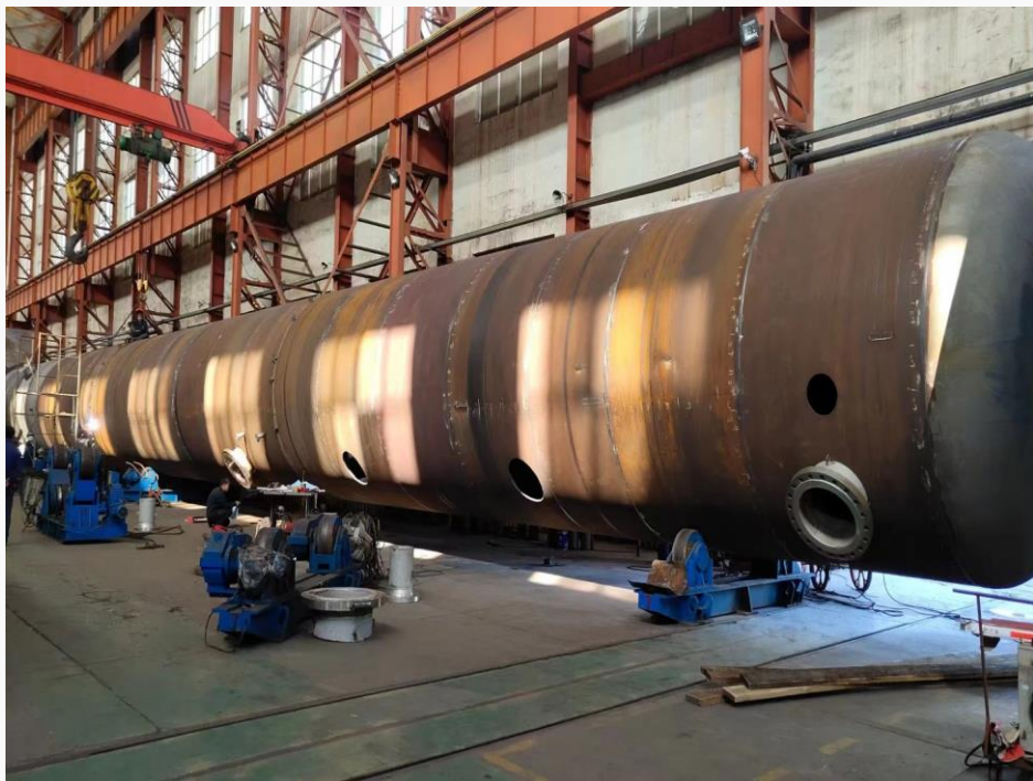
华陆工程科技有限责任公司 (延长油田伴生气资源循环利用工程) 脱丁二醇塔DN4300/2400*74900 , S30408/Q345R
