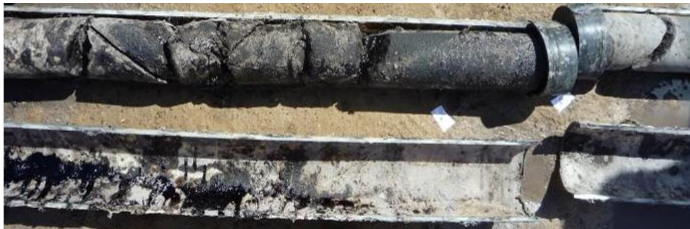
二叠系：1855-1860m 含油砂岩、泥岩互层，岩石致密
