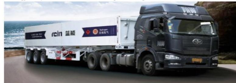
申能控股企业设计制造的碳纤维缠绕氢气拖车
